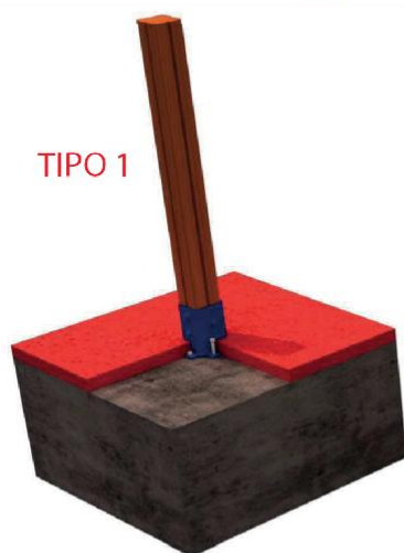
FIJACION A SOLERA DE HORMIGON
