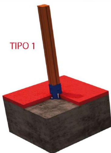
FIJACION A SOLERA DE HORMIGON
