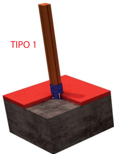
FIJACION A SOLERA DE HORMIGON
