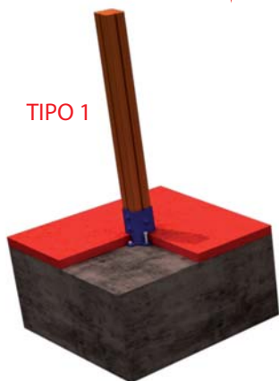
FIJACION A SOLERA DE HORMIGON
