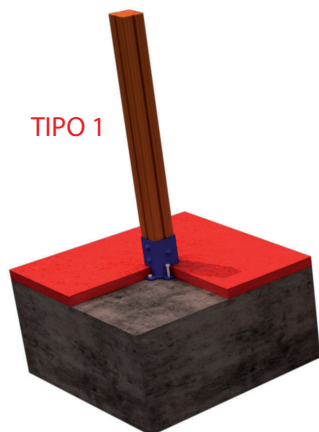
FIJACION A SOLERA DE HORMIGON
